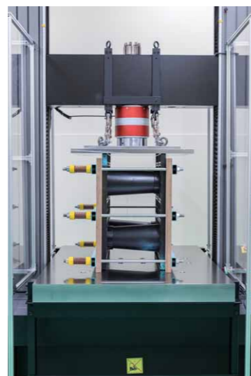
▲ 水平方向 圧縮試験風景
