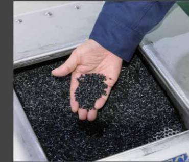
▶ 造粒機によるペレット製造
